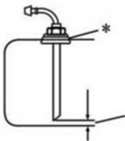
Tryska pro přívod paliva smí být namontována pouze na nádrže. kov
